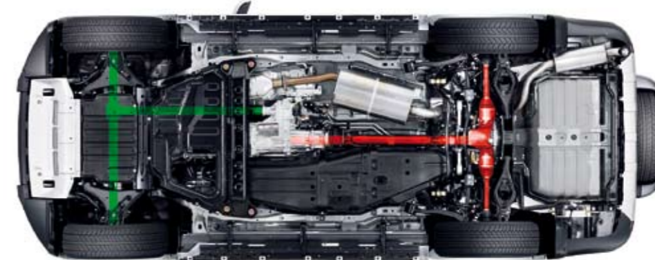
Mit abschaltbarem Permanent-Allrad, Untersetzung und Sperren für Verteilergetriebe und Hinterachse hat der Pajero eines der aufwändigsten Antriebssysteme auf dem Markt
