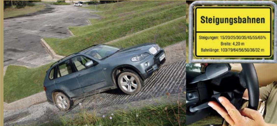
Ohne Hill-Descent-Control nimmt der BMW bereits bei der 20-Prozent-Steigung bergab Tempo auf, mit aktiviertem HDC dagegen – absolut souverän. Störend jedoch: Die Regelung über den Hebel des Tempomats muss bei jedem HDC-Einsatz neu vorgenommen werden, sie startet stets bei 9 km/h. Auf extremen Steilstücken ist das zu schnell. Bergauf geht dem Dreiliter-Diesel so schnell nicht das Schmalz aus – selbst die steilste Messstrecke bezwingt er mit jeder gewünschten Geschwindigkeit, ob
