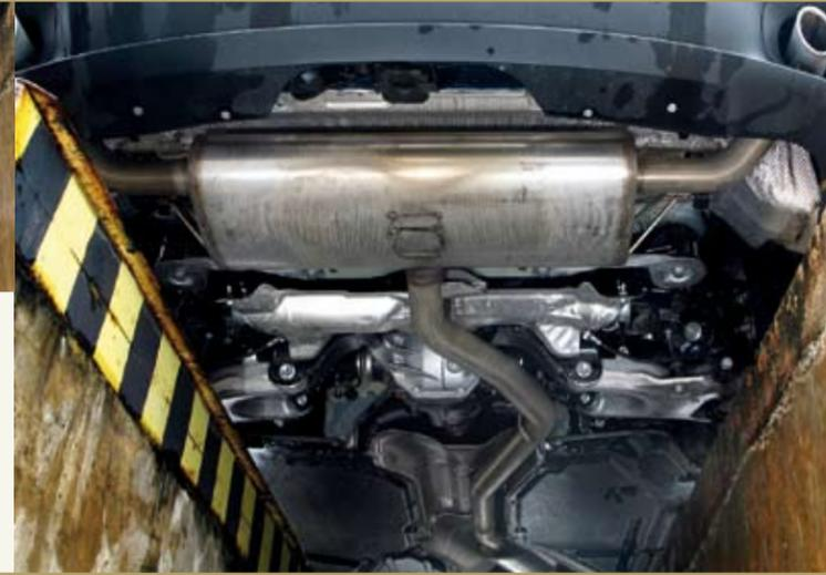
kein echter Schutz. Ungewöhnlich: Die Hinterachs-Bremsleitungen flattern lose hinter dem Achsquerschweller, das muss nicht sein und ist bei hochspreizenden Ästen gefährlich. Der ungeschützte Seitenschweller liegt extrem tief. Weit unten sitzt auch der Endschalldämpfer, von dem die beiden Auspuffrohre abzweigen. Hier kann es auf felsigem Untergrund schnell zu Beschädigungen kommen. Die reichlichen Verkleidungen verbessern zwar die Aerodynamik auf der Straße, doch bei einer Schlamm-
