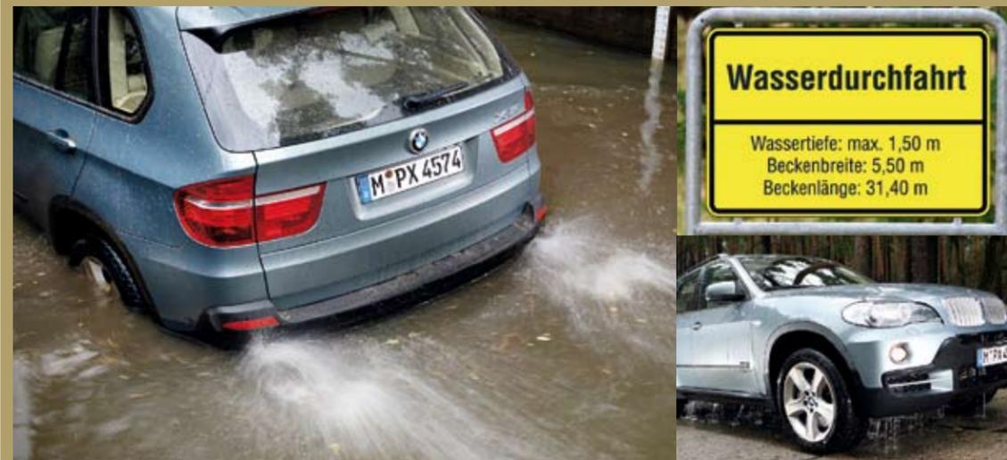
me fließt Wasser ein, Schlamm wäre da fatal. Der anspringende E-Lüfter schaufelt den Motorraum voll. Die Scheinwerfer beschlagen leicht. Und: Nach dem Test funktioniert die Heizung nicht mehr. Also: Wasser besser meiden – während der Schneeschmelze dran denken!
