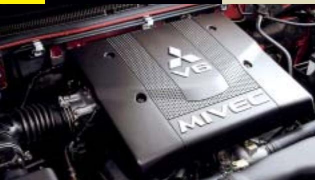
MACHT DRUCK Der V6-Benziner mit 250 PS und maximal 329 Nm bringt den Pajero mächtig auf Trab
