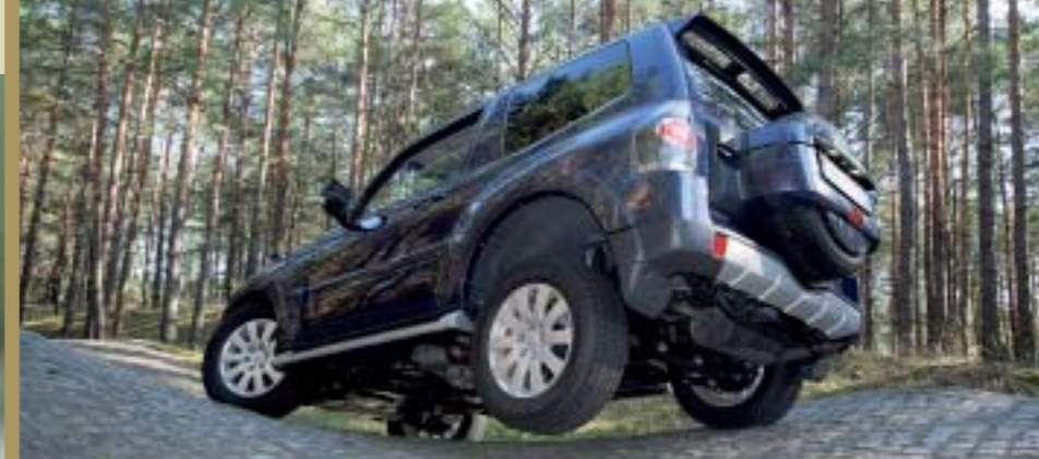
MACHT ALLES Mit dem kurzen Radstand von nur 2,55 Metern krabbelt der Pajero flink wie ein Wiesel über die Verschränkungsbahn. Deutlich am linken Hinterrad zu sehen: der große Federweg
