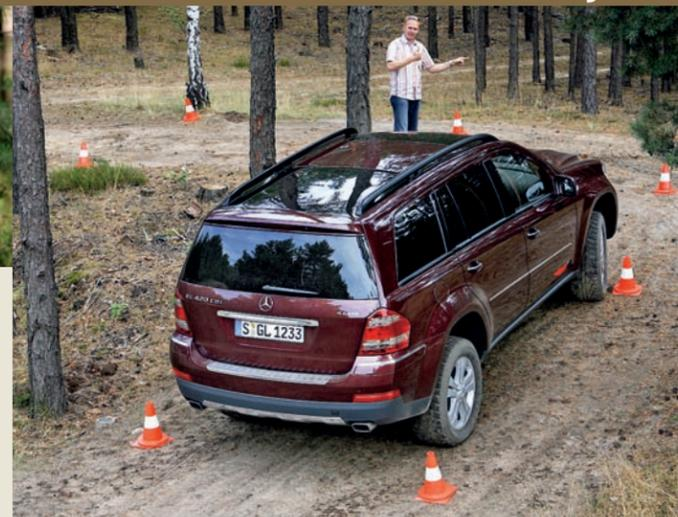
man ihm auch bei wohlwollender Betrachtung nicht attestieren. Bei dieser Länge und Breite gerät das millimetergenaue Zirkeln durch die Teststrecke zum schweißtreibenden Akt. Jede Pylone könnte ein Baumstamm sein, der seine Signatur im teuren Blech hinterlässt. Der Wendekreis ist für ein derart großes Auto zwar passabel, doch der lange Radstand macht alles zunichte. Man kommt vorn zwar gerade noch herum, touchiert aber hinten zuverlässig den nächsten Pfahl.
