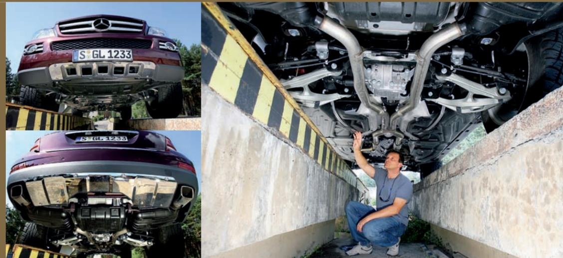
So muss es aussehen! Für diese Konstruktion verdient Mercedes großes Lob, denn sie ist wirklich durchdacht. Vom Auspuff über die Achsträger und Tanks bis hin zu den Differentials befindet sich alles in einer Ebene. Hardcore-User könnten hier ein durchgängiges Blech unterziehen und fortan mit dem GL fröhlich über Felsen schlittern. Vom vorderen Motorträger bis zum Hauptgetriebe erstreckt sich ein massiver Stahlblechschutz, unter dem sich die Ölwanne verstecken kann. Etwas
