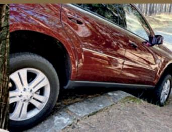
bricht bei zwei abhebenden Rädern zunächst der Vortrieb zusammen. Die Traktionskontrolle regelt dabei etwas unharmonisch, reagiert erst auf Gasstöße. Verschrägung? Nicht vorhanden, der
