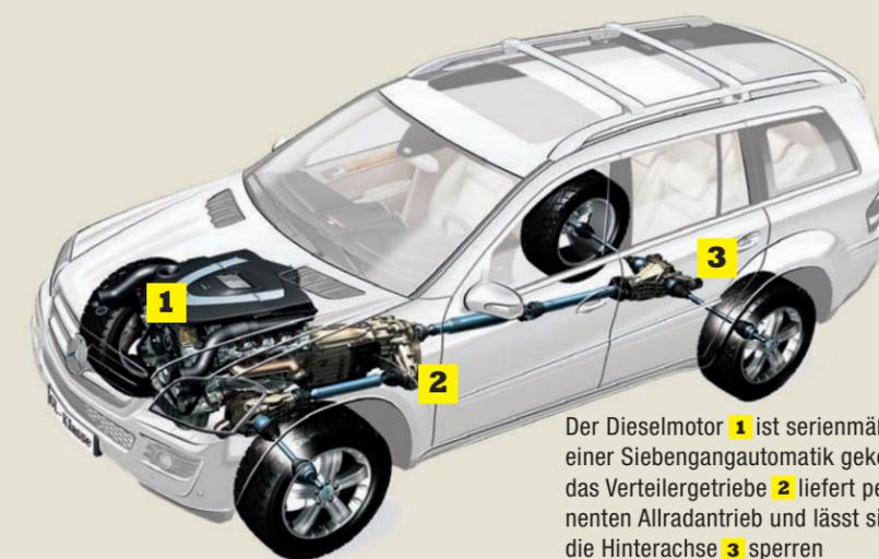
Der Dieselmotor **1** ist serienmäßig mit einer Siebengangautomatik gekoppelt, das Verteilergetriebe **2** liefert permanenten Allradantrieb und lässt sich wie die Hinterachse **3** sperren
