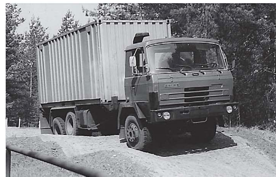
Volle Traktion: Auf der Verwindungsbahn überzeugt der Tatra 815 mit bester Verschränkung. Die typische Pendelachskonstruktion macht den Lastwagen im Gelände zum Alleskönner
