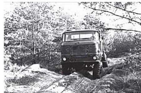
Quantensprung 1967: Der erste Allrad-W50 mit Niederdruckreifen 16.00-20 und Reifendruckregel- und Watanlage
