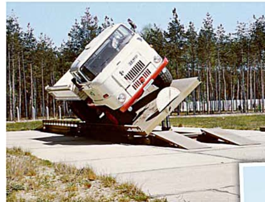
Kippbühne: Gerade liegen 38 Grad Schräglage an, das dürfte das Limit beim L 60 sein. Er ist mit Seilen vor dem Totalschaden abgesichert
