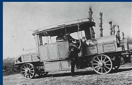
In den Müller-Straßengüterzügen erzeugt um 1900 ein rund 90 PS starker Verbrenner Energie für den Generator, der Strom für die Achsmotoren liefert
