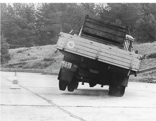
1982 führt Robur „Wedeltests mit hoher Modellbelastung“ auf der – Mitte der siebziger Jahre asphaltierten – Fläche vor den Steigbahnen durch
