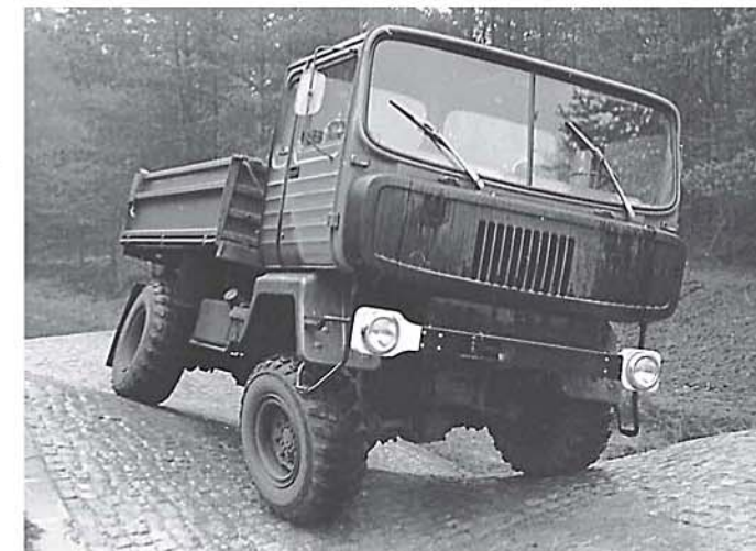
Neue Hütte auf bewährtem Chassis: Das Kippfahrerhaus 6400 sollte der Besatzung des IFA-L 60-Prototypen zu mehr Raum verhelfen. Aus Kostengründen blieb es beim alten Modell. Die Verschränkung des Fahrgestells ist sensationell
