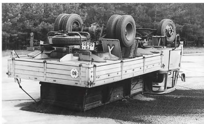
1982 führt Robur „Wedeltests mit hoher Modellbelastung“ auf der – Mitte der siebziger Jahre asphaltierten – Fläche vor den Steigbahnen durch
