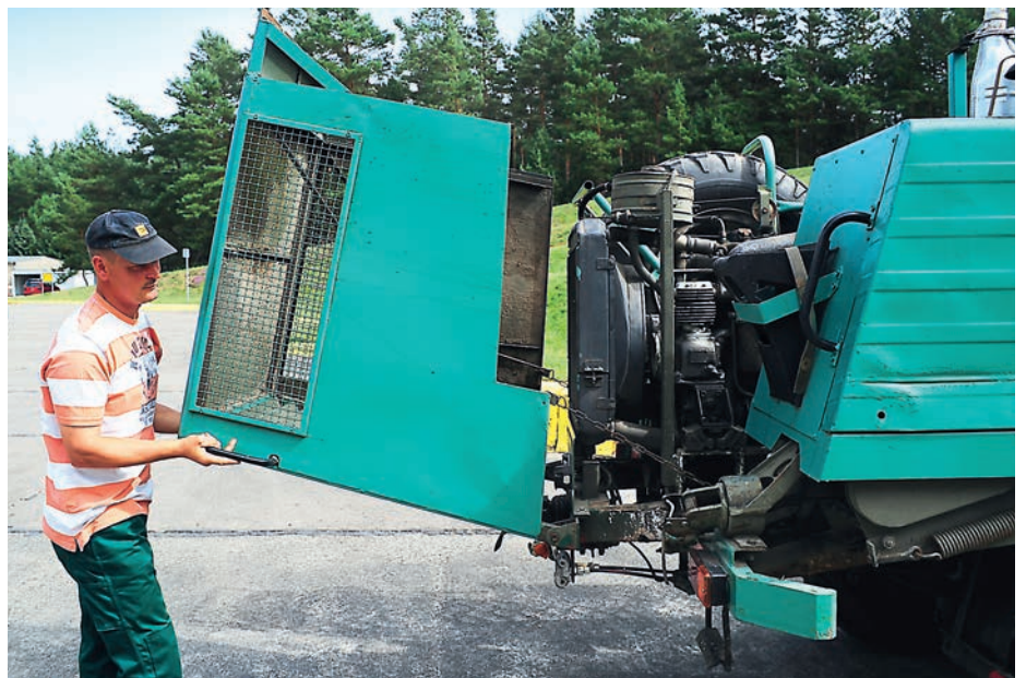
Große Heck-Klappe: GMG-Besitzer Dirk Wienigk schwenkt die Motorhaube auf, darunter verbergen sich der hinten angeordnete Kühler, die Maschine und die Hydraulikanlage
