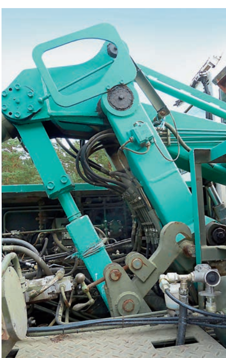
Metallfinger: Vor dem Staplerbetrieb muss der Fahrer die mächtige Sicherungsklaue für den Tragarm per Kurbeldreh entsichern
