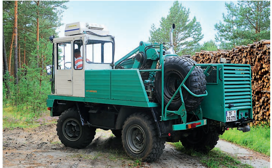
Mechanisch ums Eck: Die gerade stehenden Hinterräder zeugen vom gewählten Fahrantrieb. Mit 13,5 Meter Wendekreis meistert das kurze Mehrzweckgerät auch kurvige Engstellen
