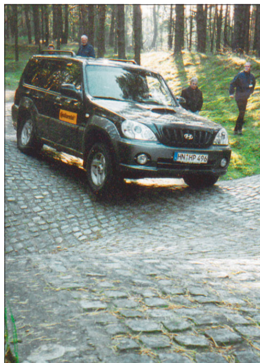
Achterbahn: Extreme Achsverstrückung, Böschungs- und Rampenwinkel sowie Bodenfreiheit werden auf dieser Strecke abgefordert.
