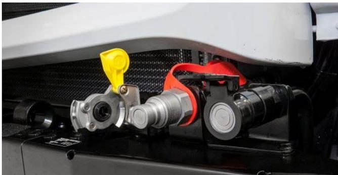
Einkreishydraulik 240 bar, 60 l/min
