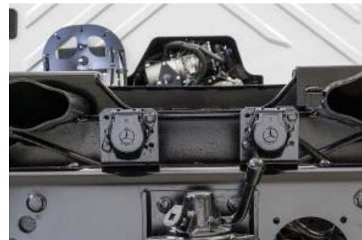
Genormte elektrische Steckanschlüsse
