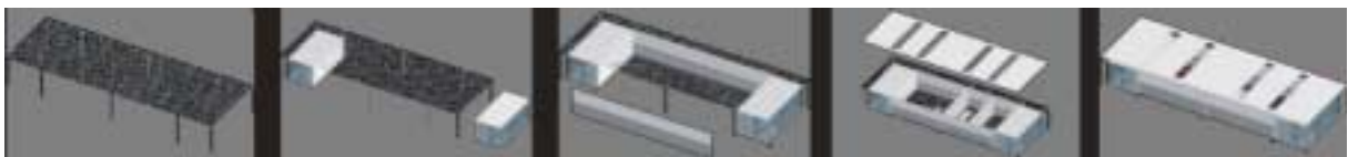
Abb. 5: Konstruktionsprinzip Werkstatt- und Bürokomplex
