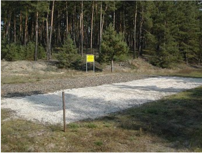
Kies- und Schotterwanne: Korngrößen: Kies 8 - 16 mm; Schotter 22 - 65 mm, Breite jeweils 5 m, Länge jeweils 15 m, Tiefe der Schüttungen: 250 mm (Kies) und 200 mm (Schotter)
