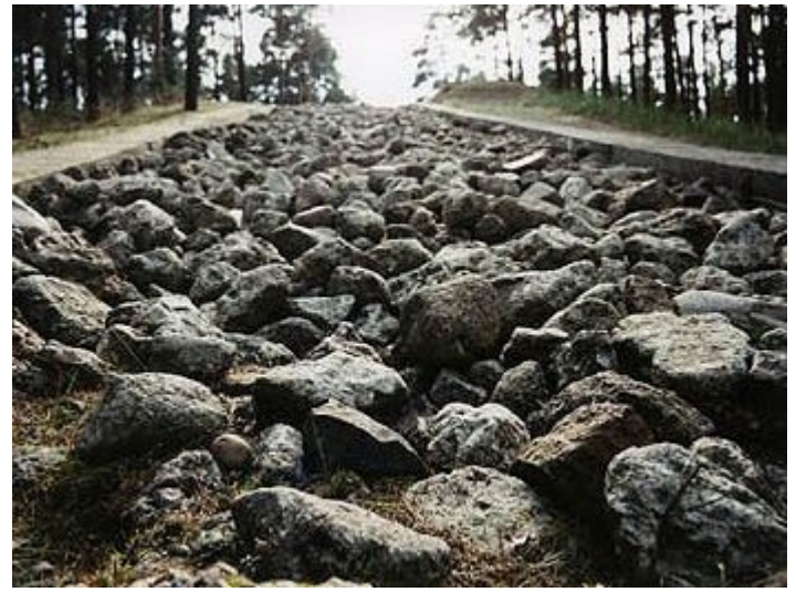
Loser Geröllhang*): Steigung 32 %, Breite: 5 m, Länge: 40 m, Belag: Geröll, faust- bis kopfgroß
