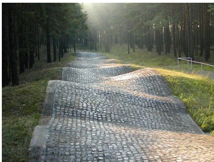
Verwindungsbahnen*): Bahn 1 - 50 m lang, max. 900 mm Amplitude; Bahn 2 - 96 m lang max. Amplitude 1335 mm, Breite jeweils: 4,40 m
