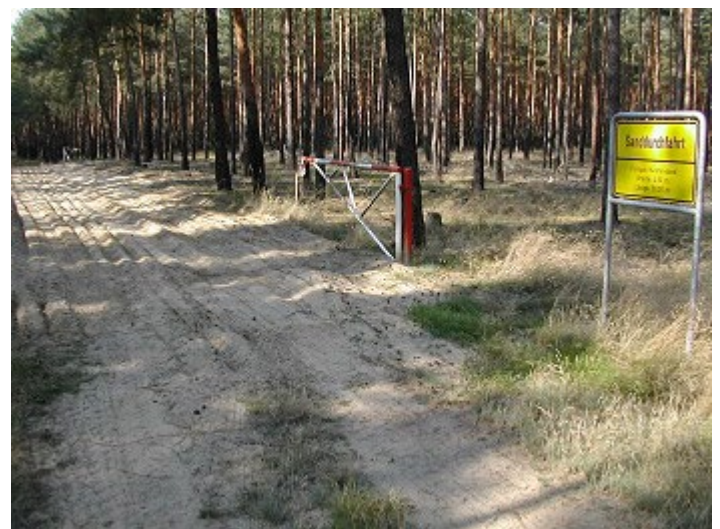
Sanddurchfahrt (Breite: 4,5 m, Länge: 50 m); Füllgut: 1 Gew.-% Schluff (Korngröße < 0,063 mm), 44 Gew.-% Feinsand (Korngröße 0,063-0,2 mm), 52 Gew.-% Mittelsand (Korngröße 0,2-0,63 mm), 3 Gew.-% Grobsand (Korngröße 0,63-2 mm).
